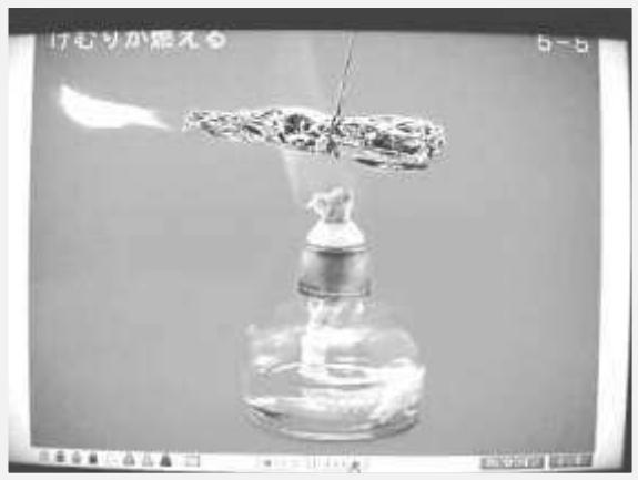
実際に実験したときの様子を動画で映した。しばらくすると、穴から出たけむりに引火するので、あわてず火に注意して加熱を続けるように説明をした。また、どの実験器具のどの部分が熱くなるかも合わせて説明をした。説明が一方的にならないよう、子どもに予想させたり考えさせたりしながら進められるとよい。
